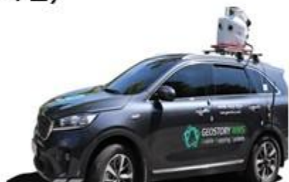
<3차원 정밀도로지도 자동구축 시스템(국토교통부, 국토정보플랫폼)>
